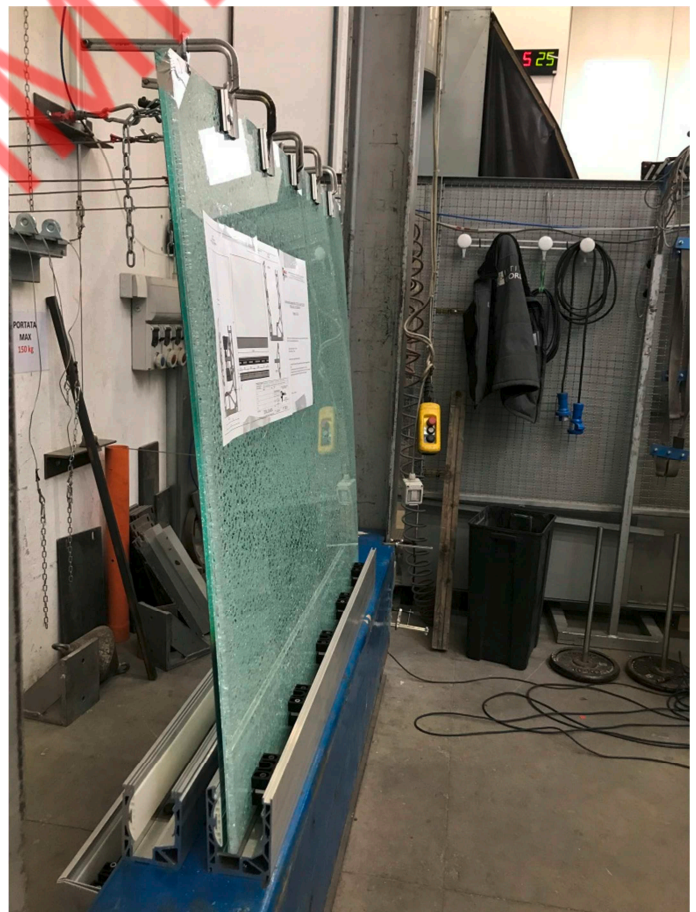
Fotografia dell'oggetto durante la prova di resistenza al carico statico lineare post rottura
